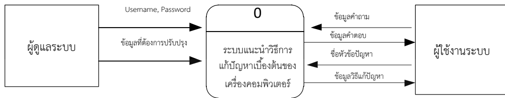
ภาพที่ 3.2 Context Diagram ของระบบแนะนำการแก้ไขปัญหาเบื้องต้น ในการซ่อมเครื่องคอมพิวเตอร์
