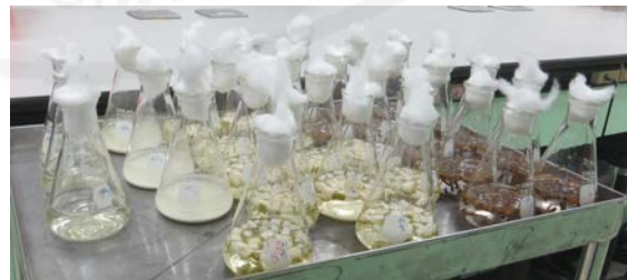
ชุดทดลองหมักเอทานอล (เปลือกส้มโอ และเปลือกกล้วย)
