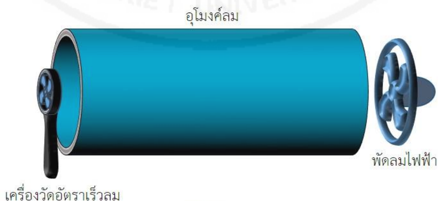
ภาพที่ 3.7 การจัดอุปกรณ์การทดลองวัดอัตราเร็วลมผ่านอุโมงค์
