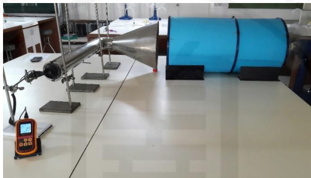
ภาพที่ 3.13 การวัดอัตราเร็วลมที่ปลายท่อของกรวยรับลม
