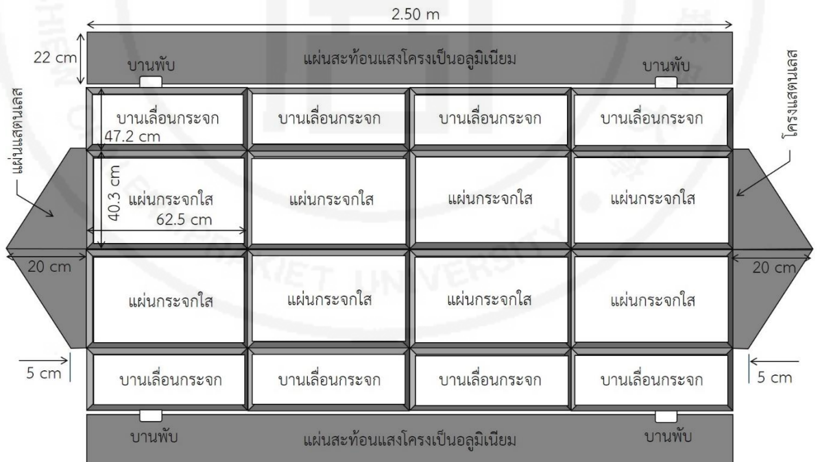
ภาพที่ 3.3 ภาพร่างด้านบนพร้อมข้อมูลขนาดของตุ้ตักพลาสติก
