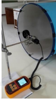
ภาพที่ 3.12 การติดตั้งเครื่องวัดอัตราลมเพื่อวัดอัตราเร็วลมที่ปลายอุโมงค์
