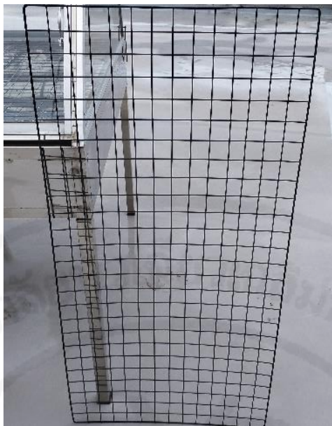
ภาพที่ 4.2 แผ่นรองตากพลาสติกภายในตู้อบแห้งพลาสติกแบบตาข่ายพลาสติก
