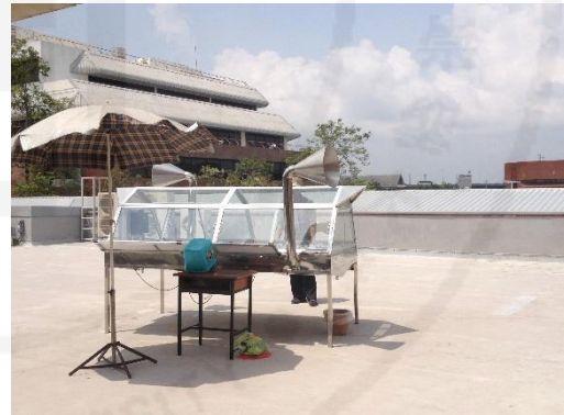
ภาพที่ ๑๑.11 การตากและบันทึกผลการทดสอบการวัดค่าของเครื่องมือวัดค่าอุณหภูมิและความชื้นสัมพัทธ์ภายในตู้อบแห้งพลาสติก
