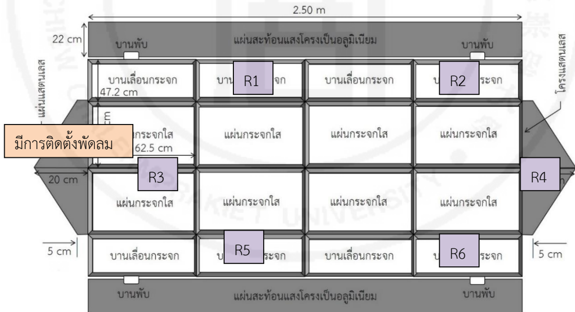
ภาพที่ 4.4 ตำแหน่งการติดตั้งตัวรับรู้อุณหภูมิและความชื้นสัมพัทธ์ (DHT22 Sensor)
