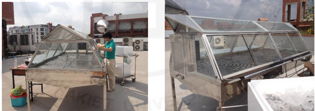
ภาพที่ ข.9 การติดตั้งตัวรับรู้ชนิด DHT22 Sensor จำนวน 6 ตัวตามจุดที่ได้ออกแบบไว้
