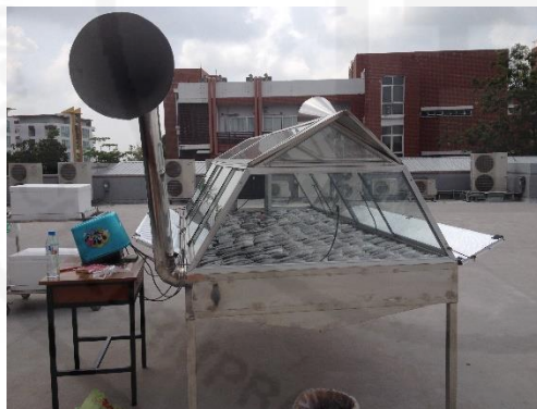
ภาพที่ ๑๑.11 การตากและบันทึกผลการทดสอบการวัดค่าของเครื่องมือวัดค่าอุณหภูมิและความชื้นสัมพัทธ์ภายในตู้อบแห้งพลาสติก
