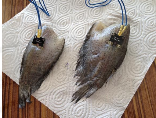
ภาพที่ ง.10 การวัดค่าความชื้นในตัวปลาด้วยตัวรับรู้ชนิด Soil Moisture Sensor Module v1 (การทดลองครั้งที่ 3)
