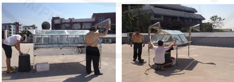
ภาพที่ ข.1 การติดตั้งอุปกรณ์เพื่อทดสอบการทำงานของ DHT22 Sensor และการทดลองตากปลาในตู้ภายหลังพัฒนาเสร็จสิ้น
