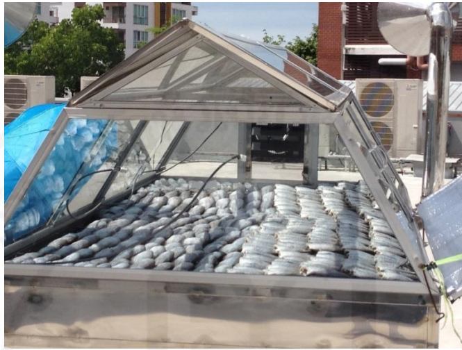
ภาพที่ ง.8 การจัดเรียงพลาสติกสดและการติดตั้งตัวรับรู้ชนิด DHT22 Sensor (การทดลองครั้งที่ 3)
