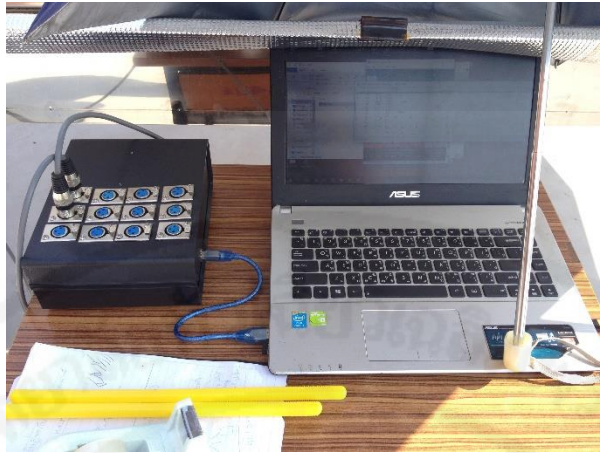
ภาพที่ ข.7 ลักษณะของเครื่องมือที่เชื่อมต่อกับ DHT22 Sensor จำนวน 2 จุดกับคอมพิวเตอร์
