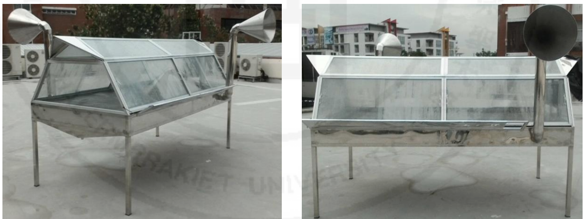
ภาพที่ 3.6 ตู้อบแห้งพลาสติกที่ดำเนินการสร้างตามแบบ
