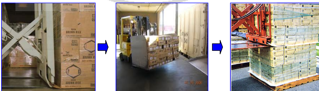
ภาพที่ 4.5 อุปกรณ์แผ่น Slip Sheet มาช่วยแบ่งสินค้าลงบนพาเลท เพื่อทำการยืนยันการรับและจัดเก็บ
