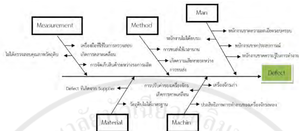
รูปที่ 1 แผนภาพแสดงสาเหตุที่เกิดของเสียในกระบวนการผลิต
