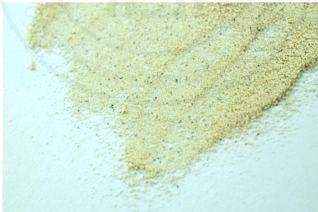
ภาพที่ 11 ภาพจากกล้องดิจิทัลแสดงลักษณะของผงดินสอพองที่ค้ำบนตะแกรงเบอร์ 140
