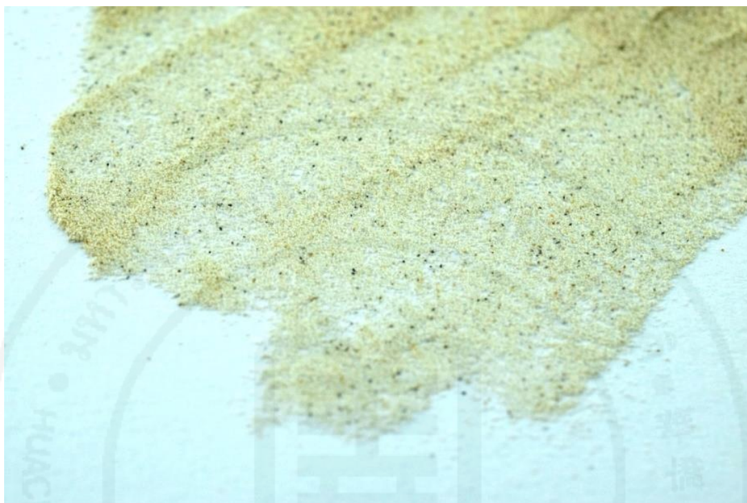
ภาพที่ 12 ภาพจากกล้องดิจิทัลแสดงลักษณะของผงดินสอพองที่ค้ำบนตะแกรงเบอร์ 170
