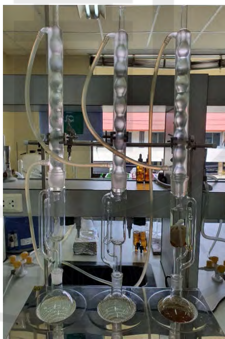
รูปที่ 3-1 ชุดอุปกรณ์ในการกลั่น Soxhlet extractor
