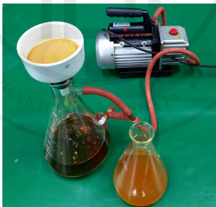
ภาพที่ 4.5 การกรองสิ่งสกัดให้ใสก่อนนำไประเหยให้เข้มข้นด้วยเครื่องกลั่นระเหยสารแบบหมุน
