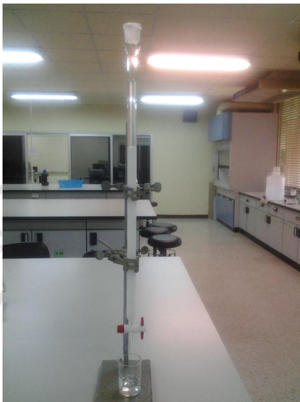
ภาพที่ 6 การทำคอลัมน์โครมาโทกราฟี
