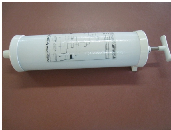
ภาพที่ 3.2 Calibration syringe (Cosmed, UK)
