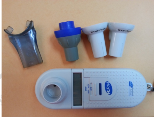
ภาพที่ 3.3 เครื่องวัดกำลังกล้ามเนื้อหายใจ Mouth pressure meter รุ่น Micro RPM พร้อมอุปกรณ์
