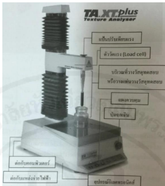
ภาพที่ 2.3 ตัวอย่างเครื่อง Texture Analyser (Stable Micro System, Surrey, England)
