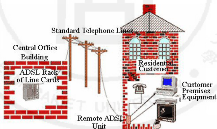
ภาพที่ 2.6 โครงสร้าง Infrastructure ของเครือข่าย ADSL
