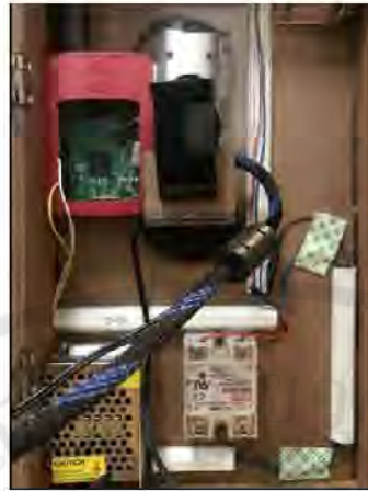
ภาพที่ 14 ระบบควบคุมการเปิดปิดประตู การเปิดปิดประตูด้วย QR code
