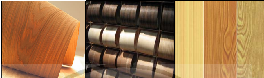
ภาพที่ 2.17 ตัวอย่างวัสดุปิดผิว Veneer
