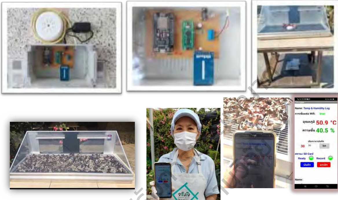
รูปที่ 4-65 ระบบติดตามค่าอุณหภูมิและค่าความชื้นในตู้ตากแห้งระหว่างกระบวนการตากแห้ง
