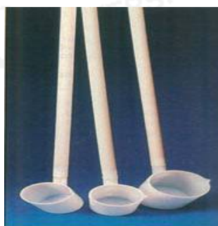
ภาพที่ 13 อุปกรณ์ในการเก็บตัวอย่างน้ำ แบบ Water sample dipper
