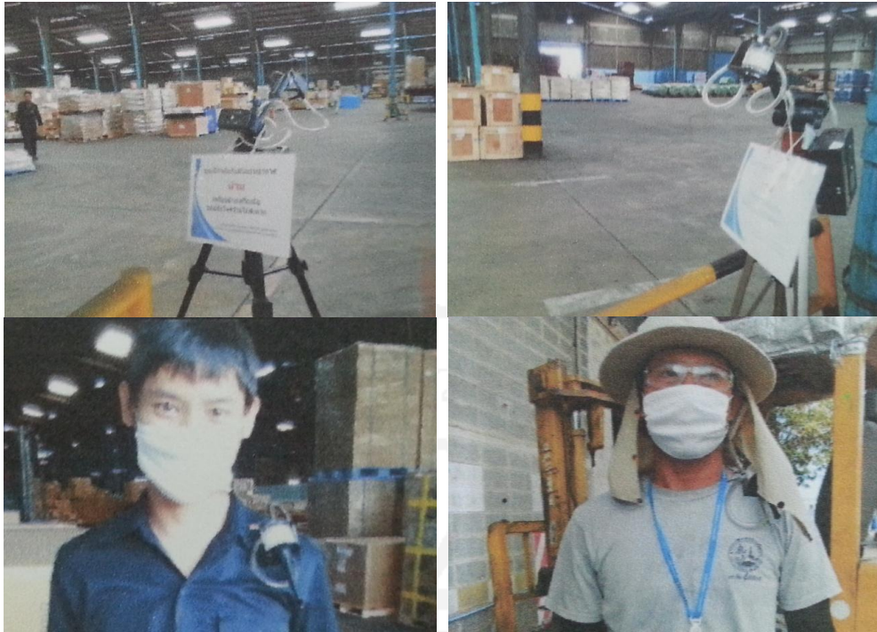
ภาพที่ 2 จุดเก็บตัวอย่างฝุ่นที่ตัวบุคคลภายในโรงพักสินค้า
