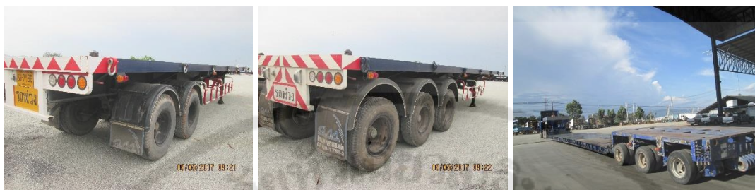
(a) หางเทรลเลอร์ชนิด 2 เพลา (b) หางเทรลเลอร์ชนิด 3 เพลา (c) หางเทรลเลอร์ชนิดไฮโดรลิก
