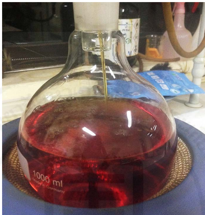
ภาพที่ 12 สารสกัดหยาบจากเปลือกมังคุดที่ได้จากการสกัดแบบต่อเนื่องด้วยชุดชอกเลต
