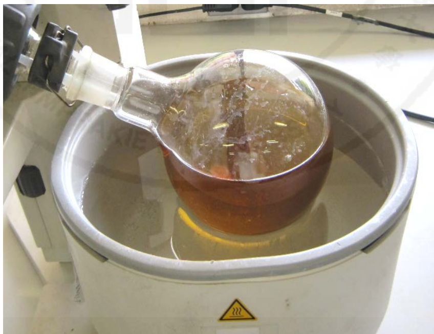
ภาพที่ 13 สารสกัดหยาบจากเปลือกมังคุดหลังการแยกสารรบกวนออกโดยการสกัดของเหลวด้วยของเหลว และนำมาทำให้เข้มข้นด้วยเครื่องระเหยแห้งชนิดหมุน
